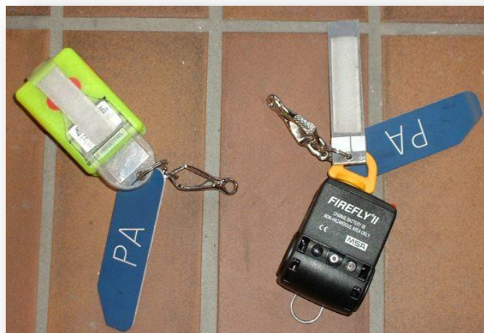
Links: Notsignalgeber mit Rückstellmöglichkeit über Tastenkombination Rechts: Notsignalgeber nur mit Schlüssel quittierbar
