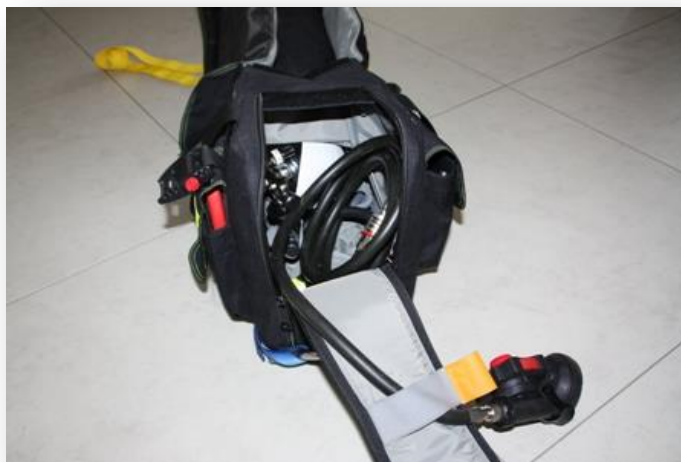
Druckminderereinheit mit Lungenautomat an verlängerter Mitteldruckleitung in der Sicherheitstrupptasche
