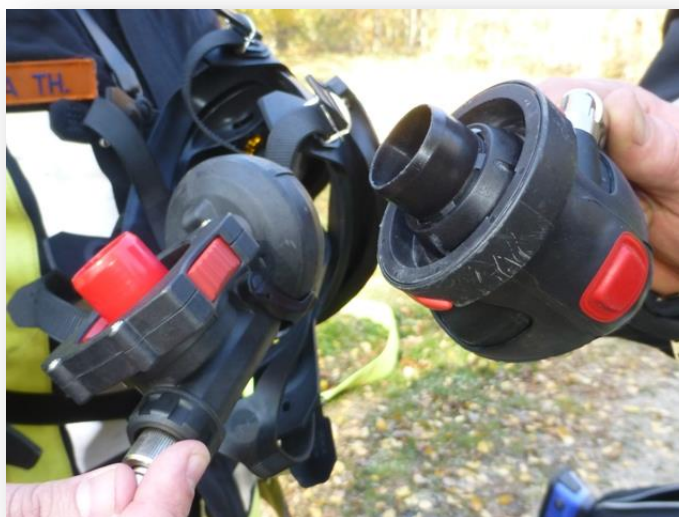
Links: ESA-Lungenautomat der Fa. Interspiro Rechts: ESA-Lungenautomat der Fa. Dräger
